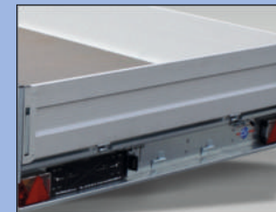
Klappe verhindert Herausrutschen der unterschieb. Auffahrschienen
